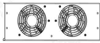
Figure 5-9 Replacement external fan module FSF
