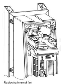
Removing internal fan
