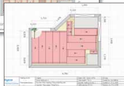
T2QuickNet installációs terv
