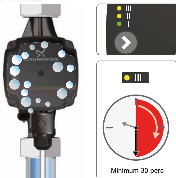
7. ábra A szivattyú légtelenítése
